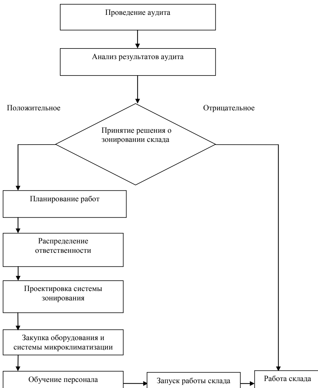
Рис. 2. Процесс разработки системы зонирования склада
