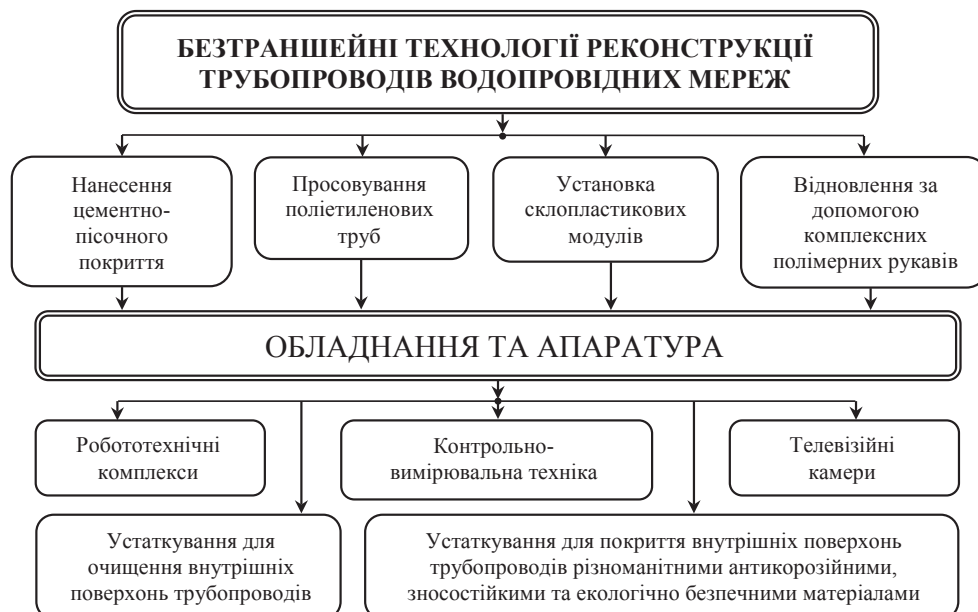
Рис. 2. Безтраншейні технології реконструкції трубопроводів водопровідних мереж та обладнання й апаратура, які при цьому використовуються
