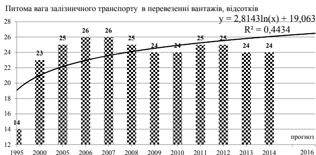
Рис. 3. Прогноз питомої ваги залізничного транспорту в перевезенні вантажів із використанням логарифмічної моделі
