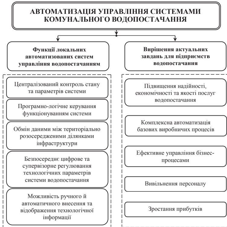
Рис. 1. Функції та завдання автоматизованих систем управління у комунальному водопостачанні
