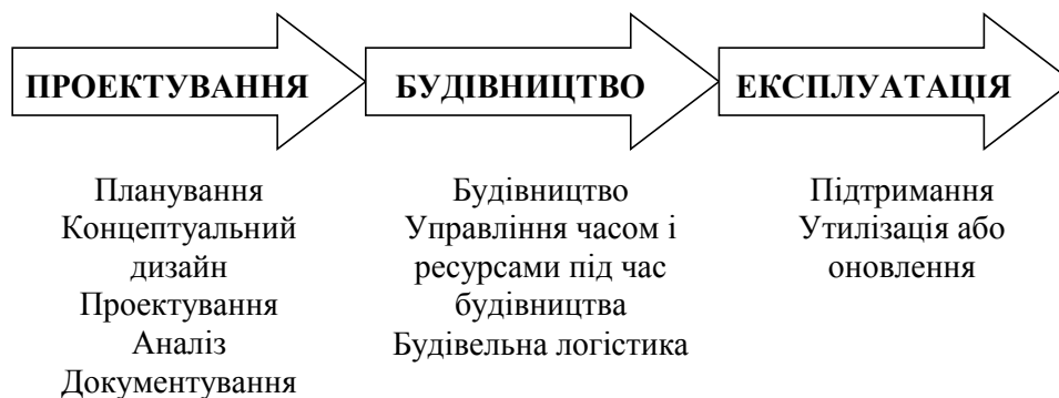
Рис. 3. Життєвий цикл будівлі в концепції BIM
